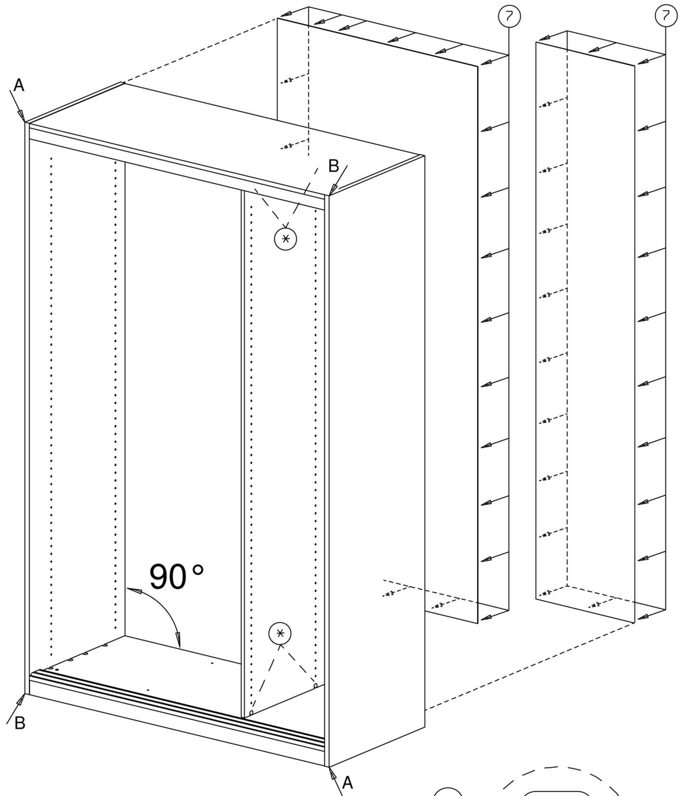
Tarkista suoruuus "ristimittaamalla" kaappi kulmasta kulmaan ennen taustalevyjen kiinnittämistä (mitta A = mitti B).
