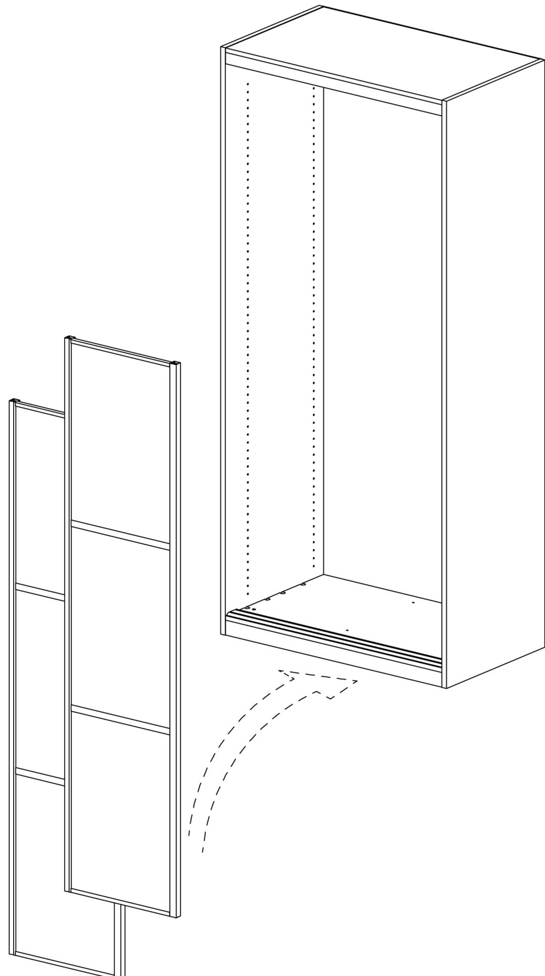
Tarkista suoruuus "ristimittaamalla" kaappi kulmasta kulmaan ennen taustalevyjen kiinnittämistä (mitta A = mitta B).
